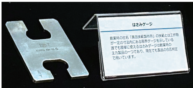
鋼板の板厚を測るはさみゲージが原点
