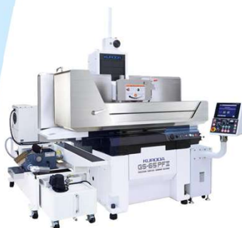
精密平面研削盤 GS-PF II シリーズ (油圧アクムレータ仕様)
